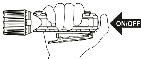
**FUNZIONAMENTO:** la torcia si accende premendo il pulsante in gomma ON/OFF. Pigiando di nuovo sullo stesso tasto, è possibile scegliere tra 2 modalità: alta o media intensità luminosa.
